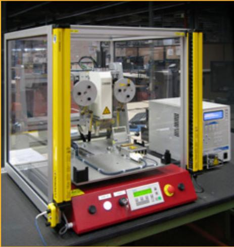
Durch Bügellöten kann man einfach lokale Verbindungen mit z.B. flexiblen Leitern herstellen.
