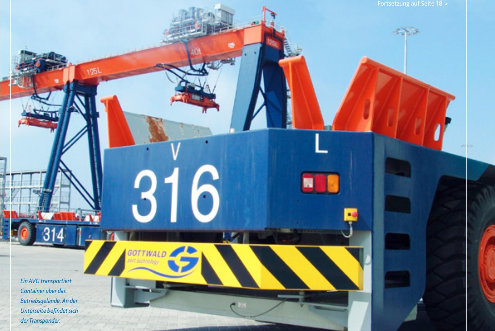
Ein AVG transportiert Container über das Betriebsgelände. An der Unterseite befindet sich der Transponder.
