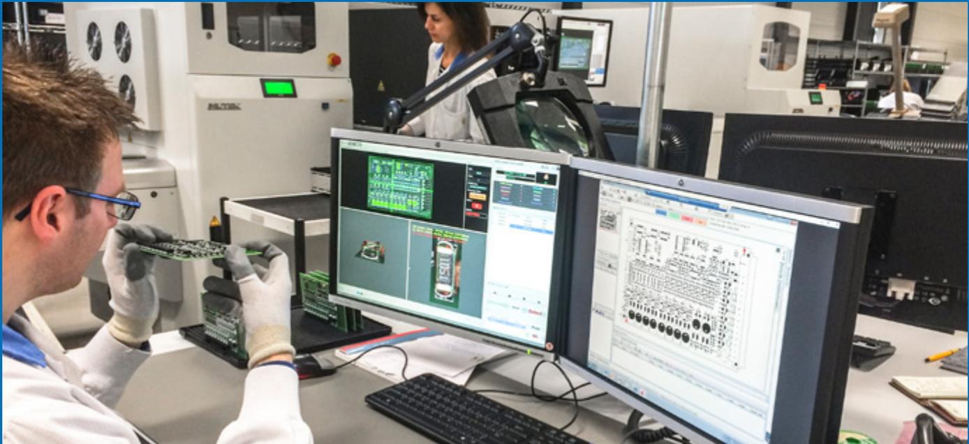
Erkannte Fehler auf der Inline 3D AOI (Automatic Optical Inspection) werden mittels der AOI Reviewstation an das Manufacturing Execution System weitergeleitet
