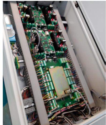
Gehäuse mit Elektronik, die die Maschine steuert
