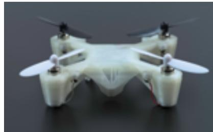
Quadcopter *Der 3D-gedruckte Quadcopter kommuniziert mit einer bestehenden embedded PCB: Magnetische Verbindungen gewährleisten den Kontakt zwischen der PCB und den gedruckten silbernen Zusammenschaltungen.*
