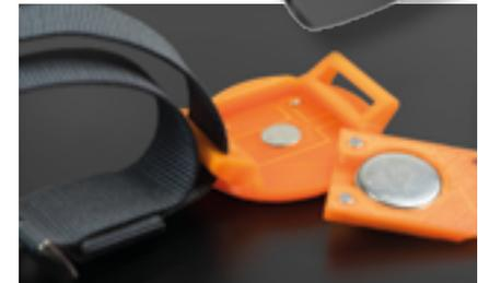
**Embedded Watch** Eine 3D-gedruckte Armbanduhr mit einem Microcontroller, LEDs und einer austauschbaren Batteriezelle.
