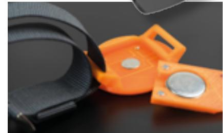
Embedded Watch *Eine 3D-gedruckte Armbanduhr mit einem Microcontroller, LEDs und einer auswechselbaren Batteriezelle.*
